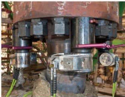
配合HYTORC垫圈无偏载轴向拉伸紧固
