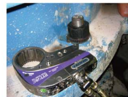
配合HYTORC螺母无偏载轴向拉伸紧固
