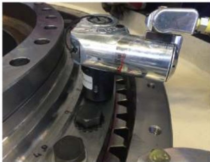
配合ZWASHER垫圈无偏载轴向拉伸紧固
