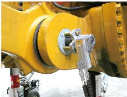
配合特殊工装，无反作用力臂轴向拉伸紧固
