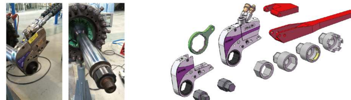
配合HYTORC螺母无支撑点轴向拉伸紧固
